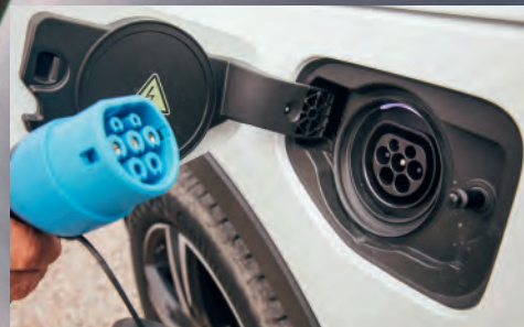
► Laddkabel Schuko Typ 2 är standard. Med 10A i vägguttaget tar en full laddning cirka 3,5 timmar.
