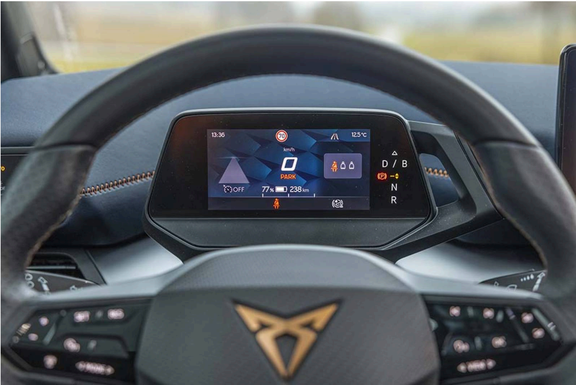
Skärm på 5,3 tum meddelar från vänster sett: status för farthållare/förarstödsystem. hastighet i siffror samt räckvidd, navigation och varningsmeddelanden.
