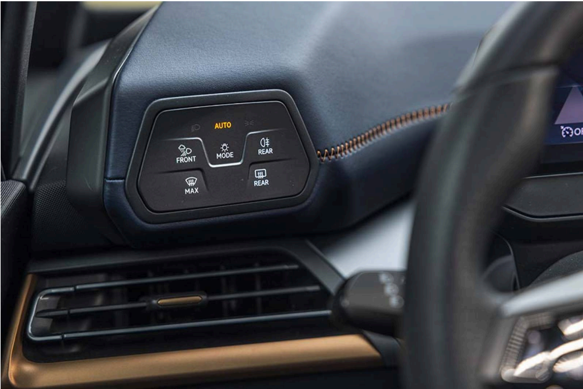
Touchknappar för halvljusomkoppling, dimljus samt defrosterfunktioner. Kontrollpanelen är identisk med Volkswagen ID.3.
