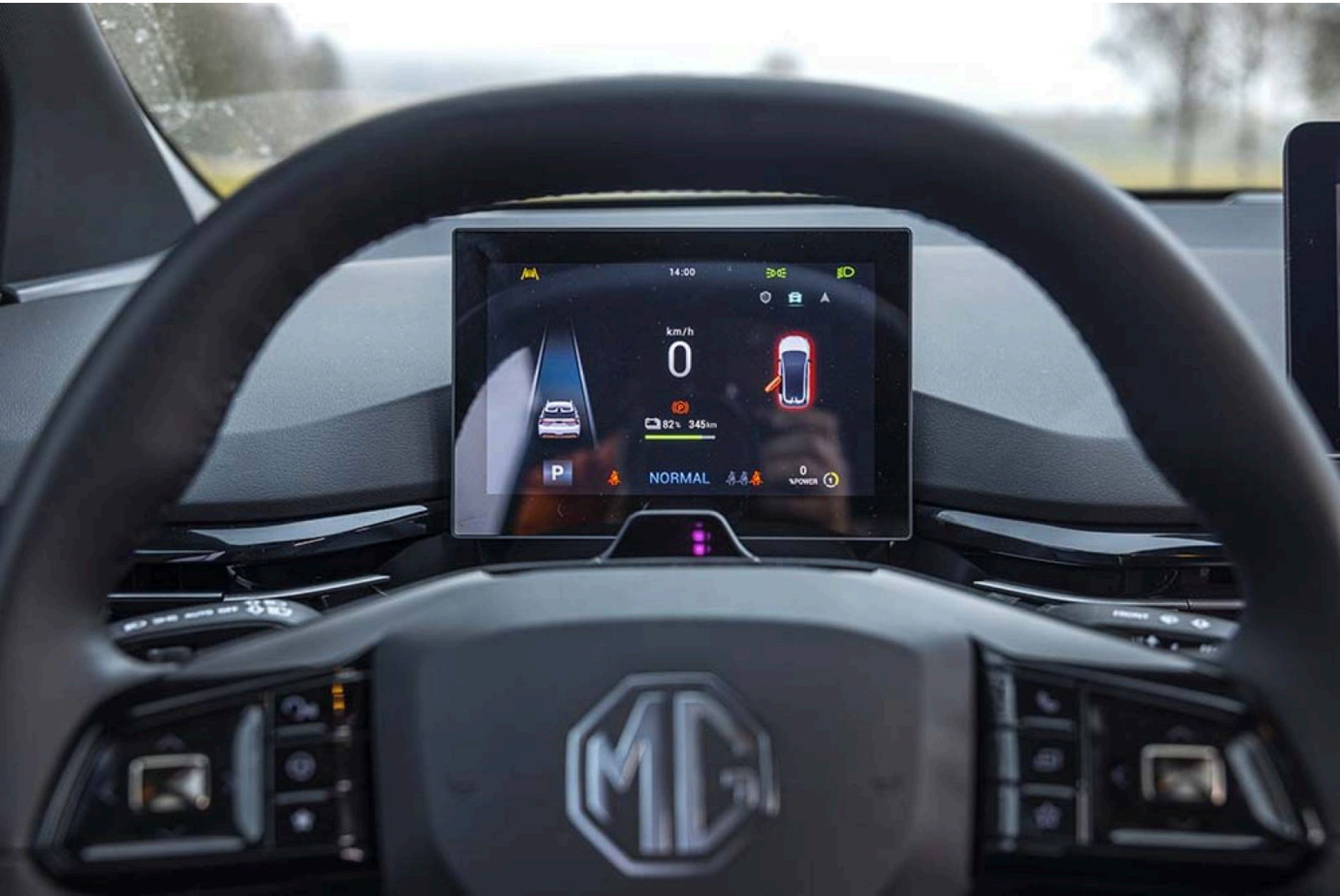
Skärm på 7 tum. Från vänster sett: status för farthållare/förarstödsystem, hastighet i siffror samt räckvidd, navigation och varningsmeddelanden. Känns det bekant?
