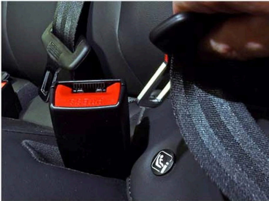
Här har MG tänkt fel. Vrid låsmekanismen 180 grader så blir det rätt.
