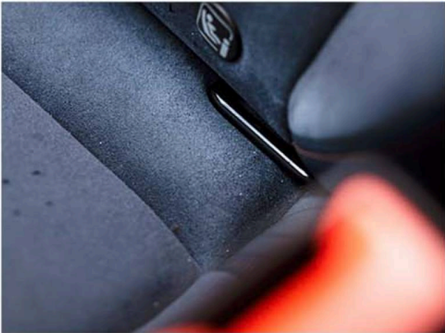
Isofixfästen fram i CUPRA . Krockkudden stängs av med nyckel.
